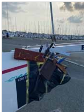
Notdürftig reparierter Rumpf
